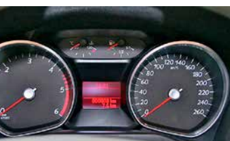
Bazowy zestaw wskaźników – dwa klasyczne, okrągłe zegary w oddzielnych tubach i mały wyświetlacz komputera.
